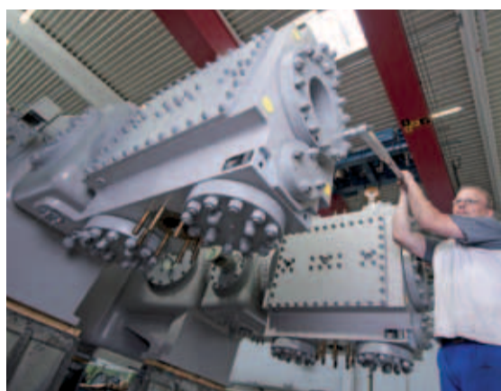
Da sind Muckis gefragt: Jörg Aretz bei der Endmontage eines Kompressors.
