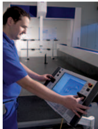
Kontrolle: Christoph Ottens Maschine misst auf den tausendstel Millimeter genau.
