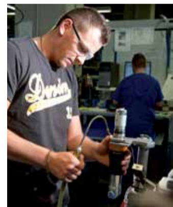
Präzisionsarbeit: Sven Krischka bei der Montage des Presswerkzeugs „Klauke Mini“.
