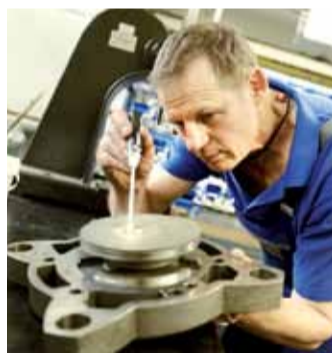
Am Firmenerfolg beteiligt: Richard Wolf baut einen Druckluftmotor zusammen.
