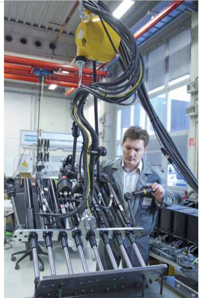
Made in Essen: Mechatroniker Alexander Steinlicht testet einen Mehrfach-Schrauber für Auspuffkrümmer.
