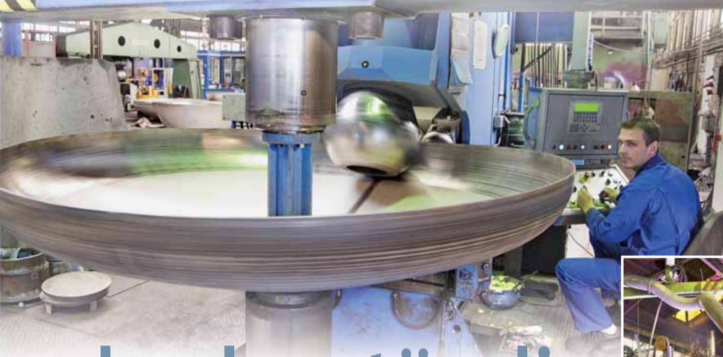
Hier geht es richtig rund: Die Maschine von Tim Küppers bringt den Rand eines Bodens in Form.
