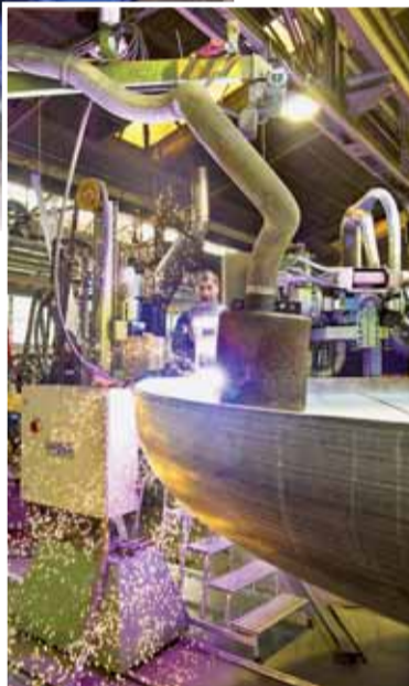
Da fliegen die Funken: Osman Maraz schleift die Kante eines Bodens ab.
