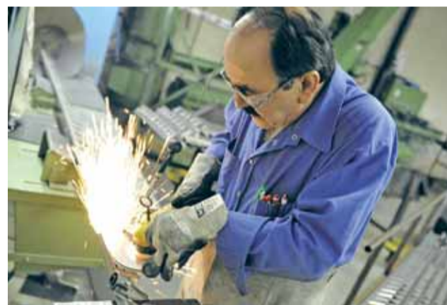
Heiße Maßarbeit: Bektas Boyraz schleift die Nietköpfe ab, damit die Messer fein aufeinandergleiten.
