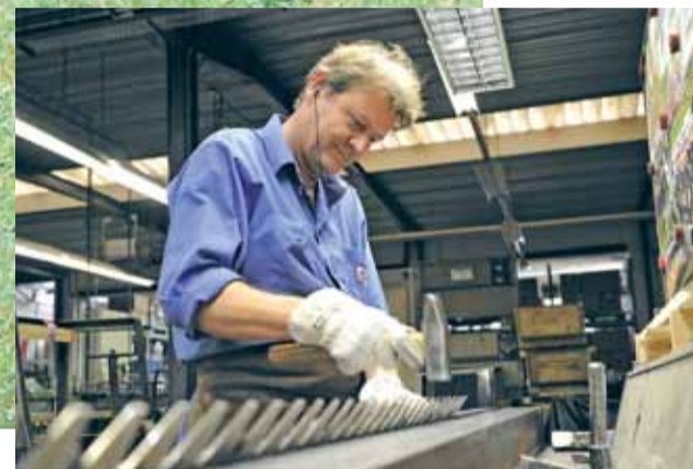
Hammerharter Job: Herbert Ochmann beim Ausrichten der einzelnen Messerklingen.
