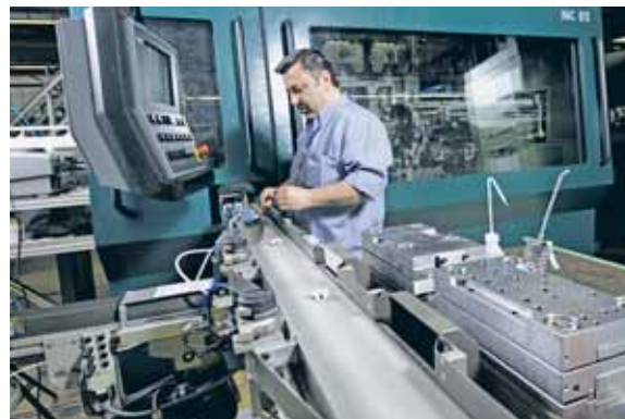
Spuckt pro Minute 240 Fassungen aus: Huseyin Gülen arbeitet an „MC 82“, einem hochmodernen Montage-Automaten. Fotos: Moll (3)
