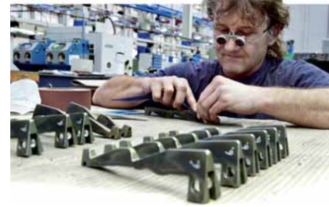
Präzisionsarbeiter: Andreas Ruszkowski prüft per Abtastsensor ein Werkzeugteil (links), während Martin Berndsen Formsegmenten den letzten Schliff gibt. Ohne Handarbeit geht's nicht. Fotos: Roth (5)
