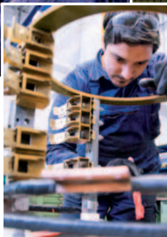
Neuanstrich einer Elektromaschine: Ersan Dönmez trägt einen Korrosionsschutz auf.
